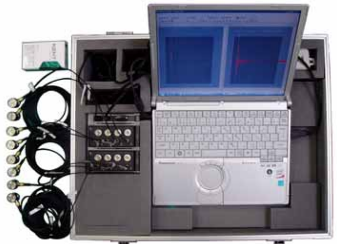
ピックアップの接続状態
